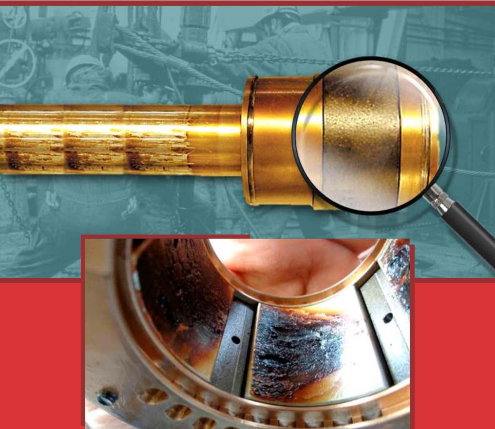
As áreas mais afetadas incluem superfícies metálicas, onde o verniz forma uma camada aderente e tenaz. Devido à sua natureza polar, o verniz é atraído para superfícies metálicas, o que facilita sua aderência e torna sua remoção particularmente difícil.
